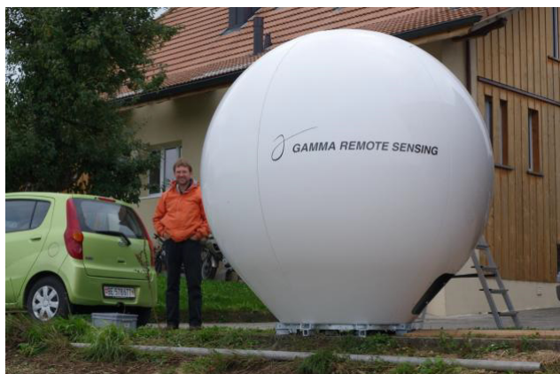
図 2 : アルミ台座付き GPRI レドーム
