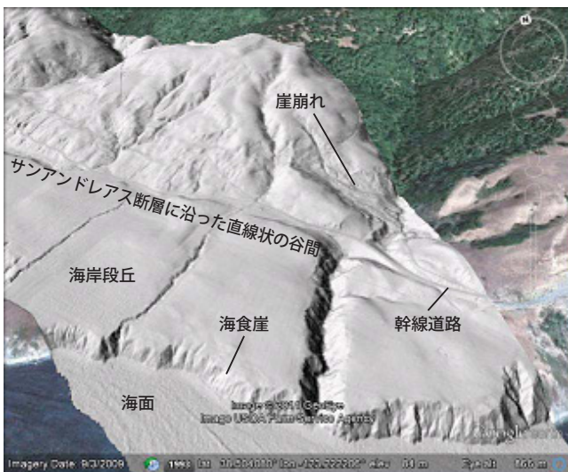
カリフォルニア州フォートロス (Fort Ross) 近辺の海岸段丘とサンアンドレアス断層を示す起伏陰影図 (Google Earth 3D タイルセット)。地形と陰影はセルサイズ0.5メートルのLidar DEMから作成。自然や人工の様々な地形的特徴をたやすく見てとることができます。
