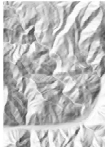
左図は、起伏陰影で表示した ASTER GDEM タイルの小さな領域で、多くの「くぼみ」の異常値を含みます。中央の図はこの領域のスタック数ラスタで、右図は比較用の起伏陰影の NED30 データです。このくぼみは、スタック数ラスタ中のスタック数が低い領域 (濃いグレーの部分) にあたります。
