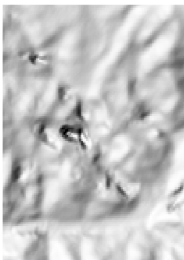
左図は、起伏陰影で表示した ASTER GDEM タイルの小さな領域で、多くの「くぼみ」の異常値を含みます。中央の図はこの領域のスタック数ラスタで、右図は比較用の起伏陰影の NED30 データです。このくぼみは、スタック数ラスタ中のスタック数が低い領域 (濃いグレーの部分) にあたります。
