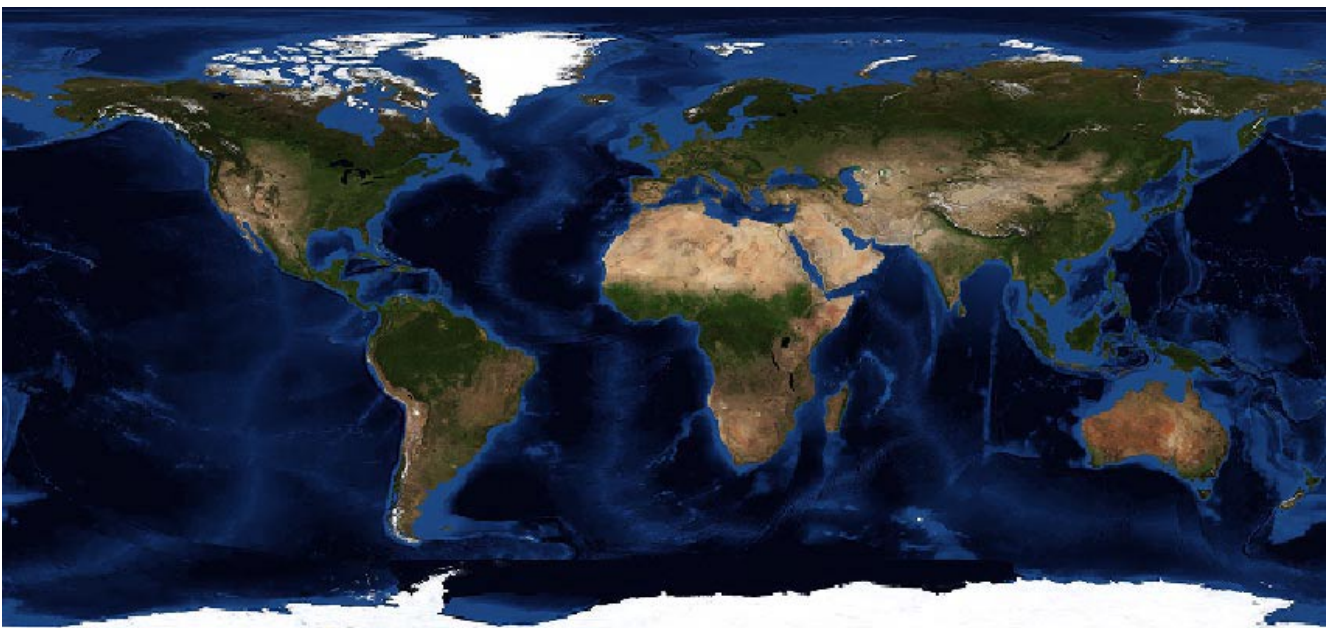
BigTIFF にエクスポートした NASA の Blue Marble の全地球画像（43,200 ライン × 86,400 カラム、セルサイズ 460m）。ファイルサイズは圧縮しない状態で 10.4GB、損失なしで LZW 圧縮した状態で 4.08GB です。
